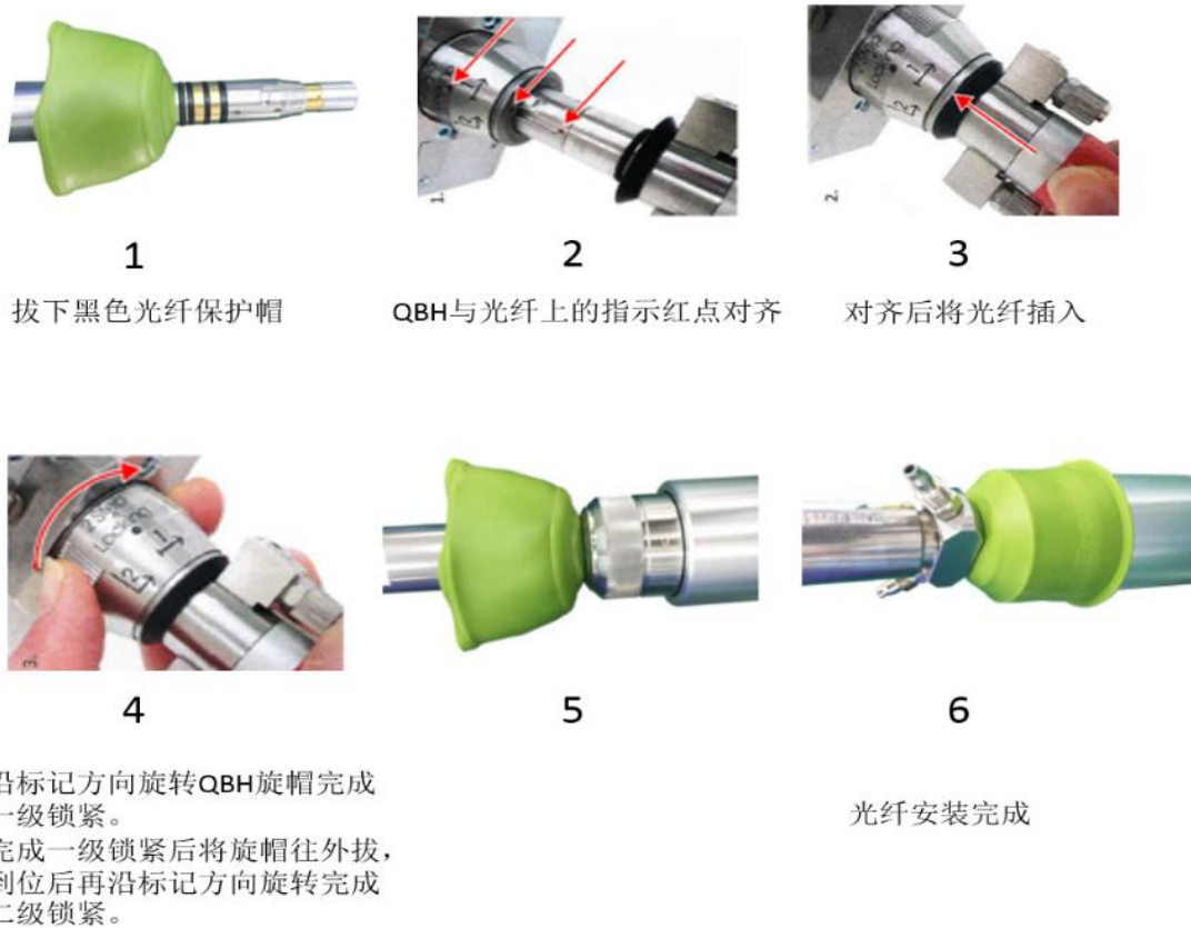
图 9 QBH 与光纤连接方法
